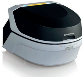
Shimadzu EDX-7000 Enerji Dağılımlı X-Ray Floresans Spektrometre USP<735> uyumlu
