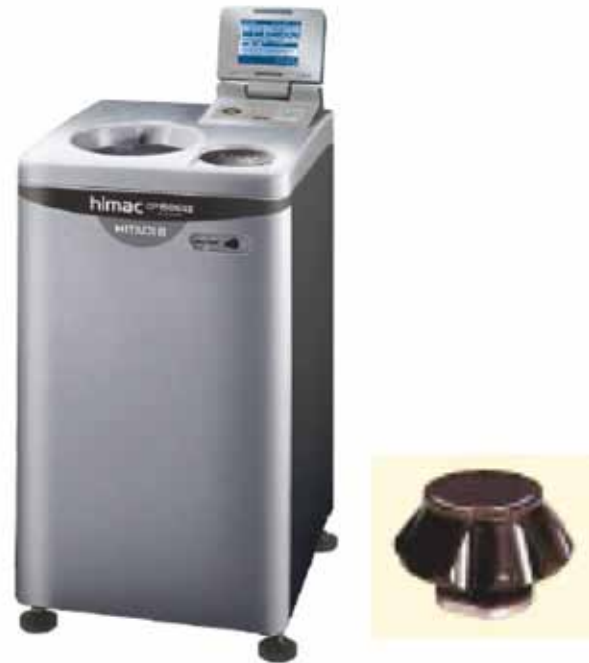
Şekil 2. CS150GX Preperatif Ultrasantrifüj ve S140AT Açılı Rotor
